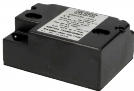
Transformateur électronique, 26KV, 30mA, primaire 230/240V, 50/60Hz,
