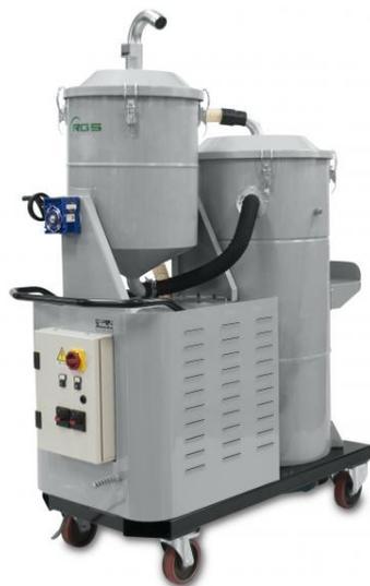
Le A 207 OIL-P est un aspirateur industriel triphasé adapté au travail en continu et intensif, idéal pour l'aspiration des huiles et boues. Dôté d'une turbine triphasée à canal latéral avec carter de protection, cet appareil est particulièrement compact avec une capacité de cuve pour liquides de 200 litres. Cette version permet de vidanger les liquides pendant l'aspiration.
