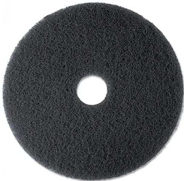
Le disque Hi Pro dispose d'une structure ouverte très résistante. Son pouvoir décapant est 4 fois plus performant. Sa performance est uniforme du début à la fin du disque. Utilisable en monobrosse ou autolaveuse jusqu'à 250 tours/minutes.
